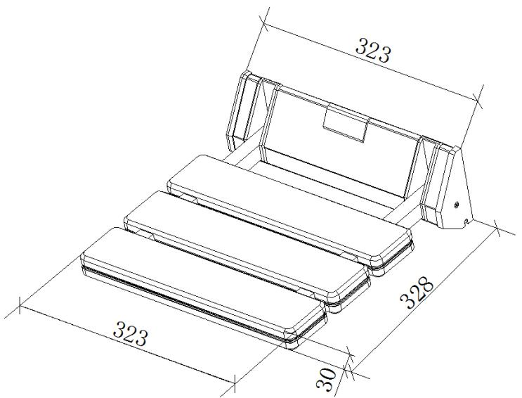
**DE** Positionieren sie den Duschsitz in der Höhe an die Wand, auf welcher sie den Sitz montieren möchten (empfohlene Höhe ca. 45 bis 55 cm) und markieren sie die Löcher an der Wand. Nehmen sie den Sitz wieder von der Wand. Bohren sie die Löcher in die Wand and geben die Dübeln in die Löcher.
